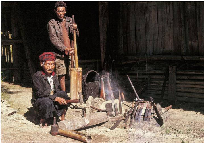
圖 7 山田燒壑農民中手巧的男子鍛造柴刀、鋤頭以及前裝式打火石槍。使用兩管竹筒風箱送風、燒炭生火。克欽人的鍛冶技術自古以來即很純熟（恩梅開江和 Kurun 河交匯一帶 Bugopapu 村）。
